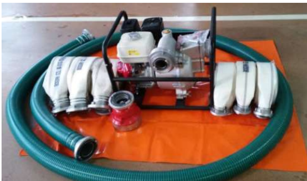
Zdjęcie 6. Pompa do wody brudnej wraz z osprzętem.
